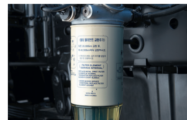
4. Основной топливный фильтр с подогревом
