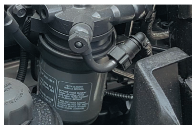
5. Второй топливный фильтр (только для Евро-5)
