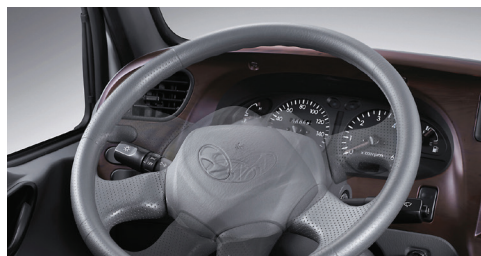
Гидравлический усилитель руля и регулируемая рулевая колонка по высоте и наклону
