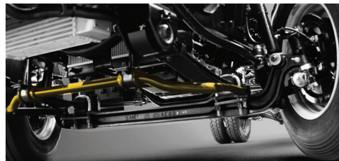
Стабилизатор поперечной устойчивости для надежности и лучшей управляемости
