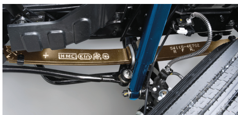
Модернизированная передняя подвеска и амортизаторы
