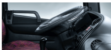
2. Рулевая колонка с регулировкой наклона и вылета
